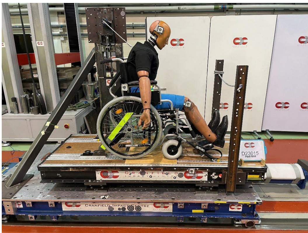
(Kolečkové křeslo 0811300 během nárazového testu)
